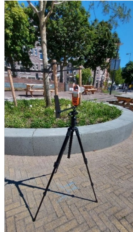
Figuur 8 Foto links: meetopstelling met meetpunt in het schaduwpatroon van de boom (Int-1) en het referentie punt (Ref-1). Bron: Cool Towns Heat Stress Measurement Protocol (Spanjar et al., 2020); Foto rechts: Kestrel 5400, mobiel weerstation.
